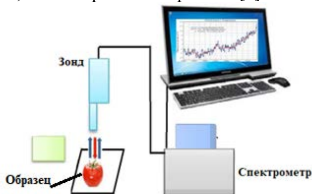
Рис. 1 Рамановская система контроля зрелости томатов
